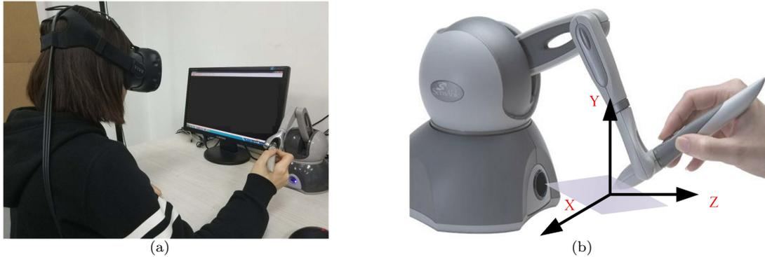
图 4 融合多点接触力反馈的沉浸式交互环境 (a) 硬件系统; (b) 触觉交互
